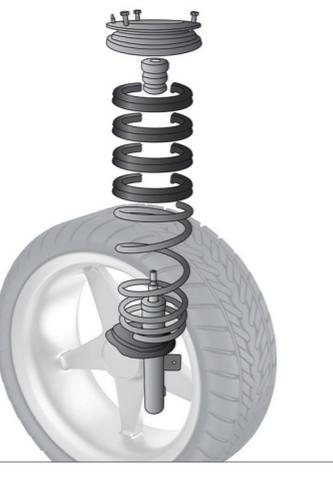
SPACCR® über (alternativ unter) der Feder einlegen
