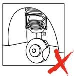
**Die Feder kann nicht in eingebautem Zustand gespannt werden.**
